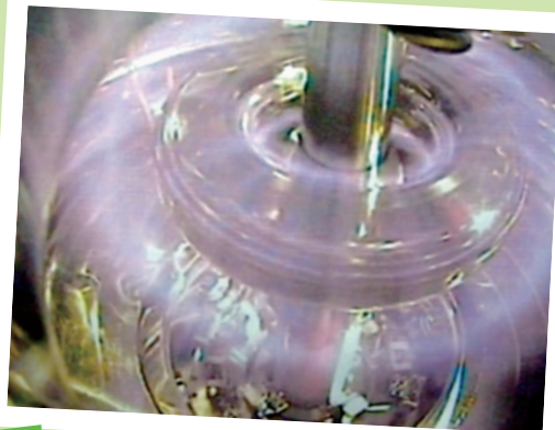
図. 超電導で浮かせたコイル（写真中央部）の周りにプラズマを引き寄せて保持している
