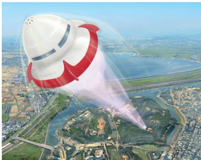
図1：電磁ビームロケットシステムのイメージ図 地上の発射基地からビームを照射されロケットが進む。もちろん地上基地は一度作ってしまえば何度も使える。
